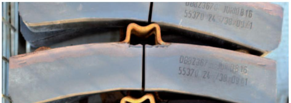
Seit Februar 2007 gelten für alle neuen Schienenfahrzeuge einheitliche Grenzwerte für deren Geräuschemissionen. Diese Lärmreduzierung wird bei neuen Güterwagen durch den Einsatz der leisen Verbundstoffbremssohle (Typ „K-Sohle“) erreicht.
