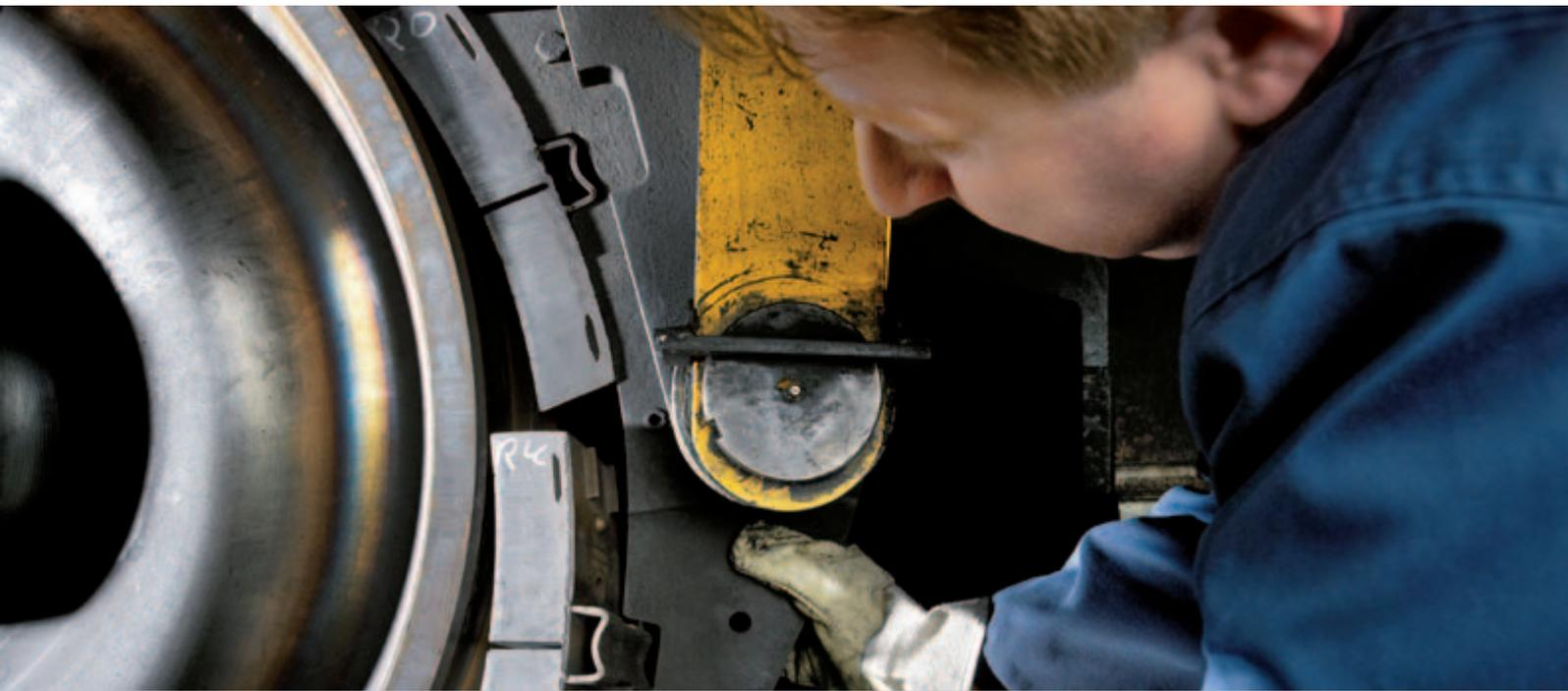
Ziel der DB AG: Bremsklötze mit Grauguss-Sohlen durch die Verbundstoffbremssohlen zu ersetzen
